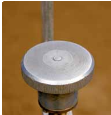
7. Holdeværktøjet skal spændes så meget, at skruen i midten af holdeværktøj flugter.
