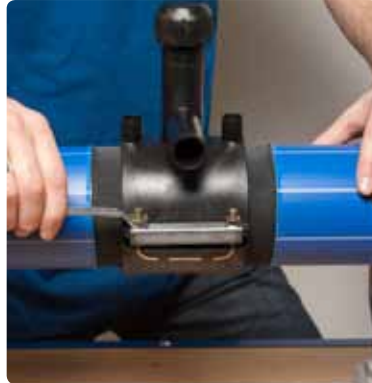
6. Sæt formstykket fast på ProFuse-røret med holdeværktøjet.
