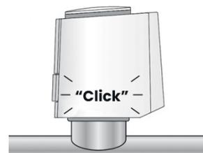
3. Pousser vers le bas pour enclencher l'actionneur sur la bague
