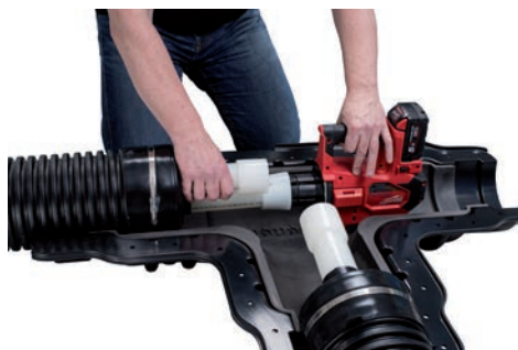
Bild 2 Expandera rörändan tillsammans med ringen. Autoroteringsfunktionen säkerställer en jämn expansion.
