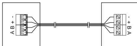
Bild: Termostat och reglercentral (4-ledad)
