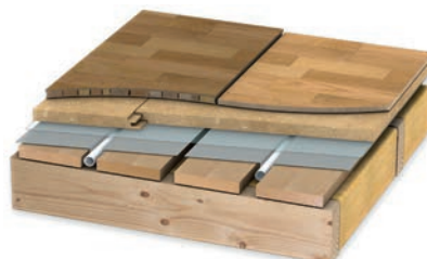
Bild: På träbjälklag
