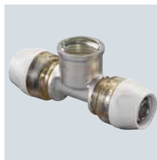
Uponor RTM T-stuk met binnendraad – met geïntegreerde persfunctie, persmarkering, kleurcodering en cilindrische binnendraad conform ISO.
