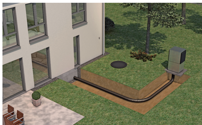
Ligação com Uponor Ecoflex Thermo Twin HP entre uma bomba de calor externa monobloco e um edifício residencial.
