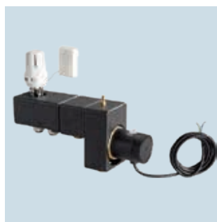
Uponor Fluvia T Push-12 Kleinstpumpengruppen für Einzelräume und kleine Heizflächen. Raumtemperaturregelung wahlweise über Thermostatkopf mit Kapillar-Raumtemperaturfühler oder Uponor Raumfühler (drahtgebunden oder Funk) mit Thermoantrieb. Ideal zum Anschluss der Flächenheizung an ein bestehendes Hochtemperaturnetz.
