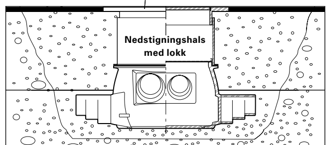
Prinsippskisse for plassering av Ecoflex-brønn under kjørbær flate, for eksempel en asfaltert vei med kjørbær flytende tildekning. Brukes hvis brønnen skal kunne inspiseres.
