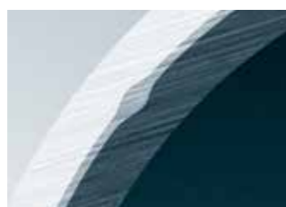
Warstwa aluminium zgrzewana doczołowo
