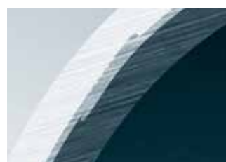
Warstwa aluminium zgrzewana na zakładkę
