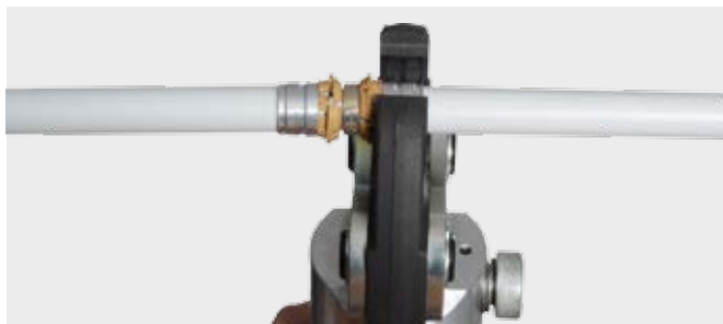
Prešana čeljust postavlja se na zaustavni prsten na prešanoj čahuri.
