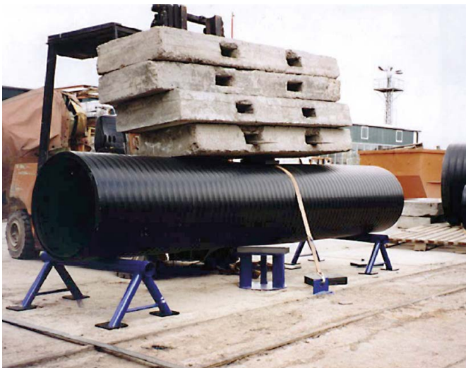
Pituusjäykkyyksikoe DN/ID 600 SN4-luokan putkella. Kuorma 29 kN, taipuma 30 mm, putken muodonmuutos 54 mm.
