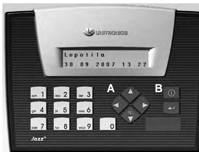
A Piltangenter som behövs för navigering i programmenyerna. B Enter, som godkänner val.
