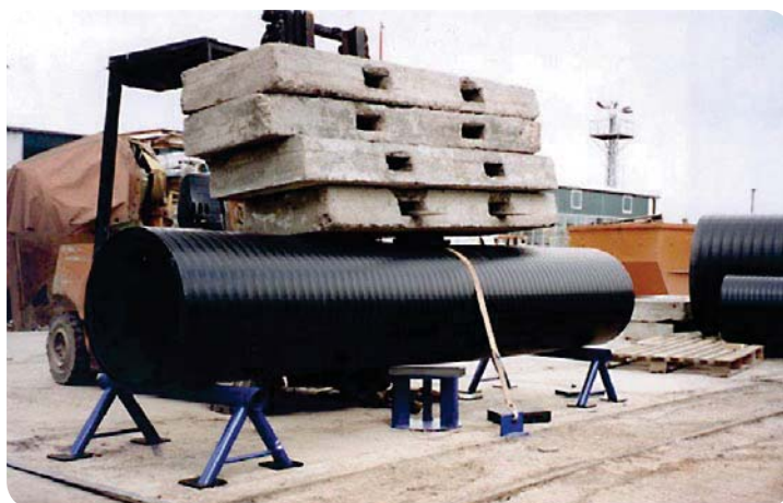
Garenvirziena stinguma pārbaude DN/ID 600mm, SN4 caurulei. Slodze 29kN. Izliece 30mm, caurules deformācija 54mm.
