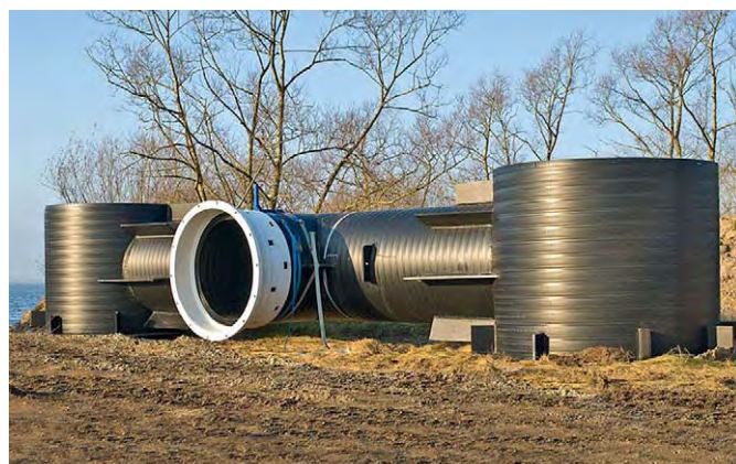
▲ För att inte suga in sediment och andra orenheter i marina intagsledningar, behövs i de flesta fallen en intagsstruktur.
