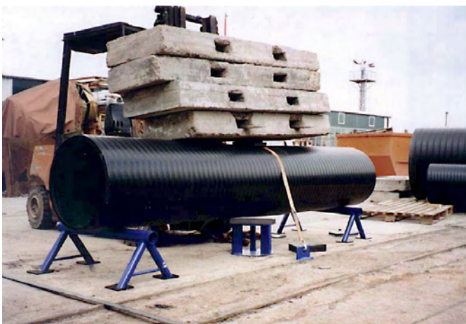
▲ Längdstyvhetstest med DNIID 600 SN4 rör. Belastning 29 kN, böjning 30 mm, rörets deformation 54 mm.
