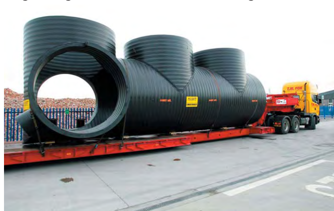
▲ Storbritannien: en specialkonstruktion som tillverkats på fabrik, DN/ID 3000 mm hör till ett utjämningsmagasin på 300 m 3 , vikt ca 5 ton. Installationen, inklusive schaktning tog två dagar. Jämfört med traditionella metoder sparade man både omgivning och flera veckor av arbete..
