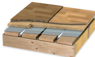
Bild: På träbjälklag
