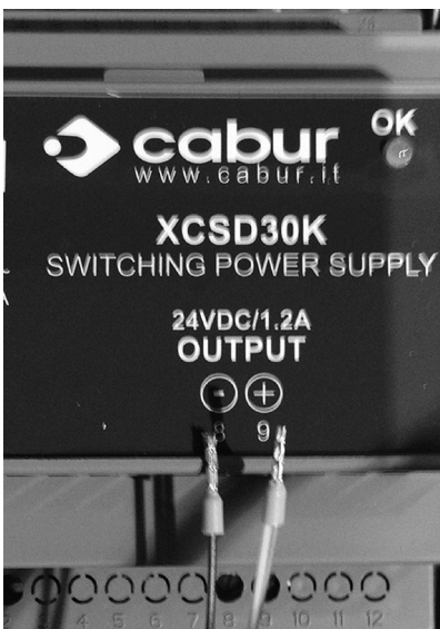
7. Anslut den röd/gula kabeln till + på transformatorn samt den svarta på -
