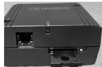
8. Tryck in den gula knappen, ta ut SIM-korts-hållaren och lägg i SIM-kortet.
