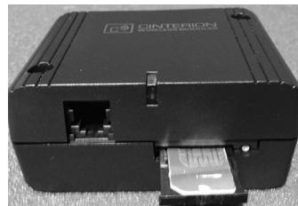
8. Tryck in den gula knappen, ta ut SIM-korts-hållaren och lägg i SIM-kortet.
