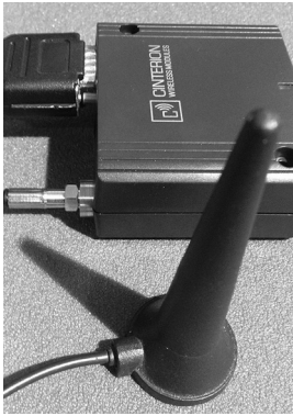
5. Anslut antennkabeln till modemet samt strömförsörjningskabeln.
