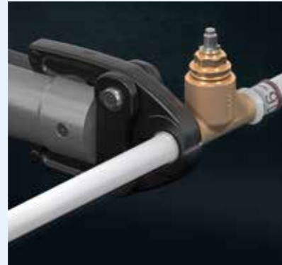
2 Verpressen durch präzise Pressbackenführung
