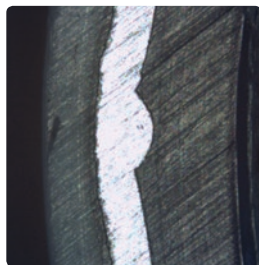
Warstwa aluminium zgrzewana doczołowo
