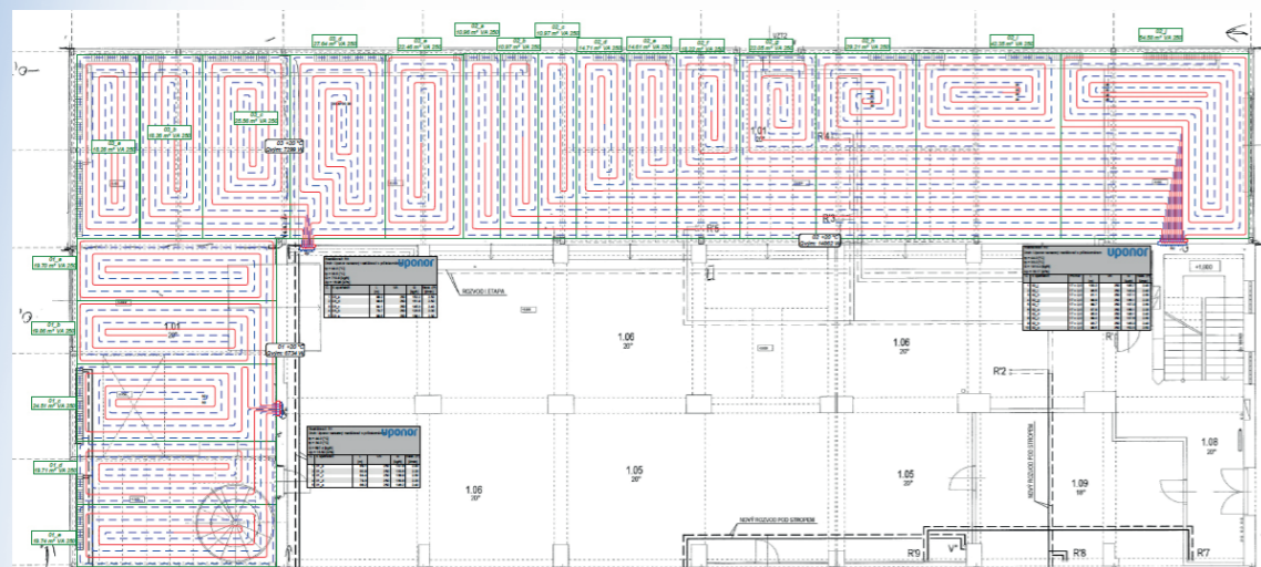
Návrh podlahového vytápění v programu Uponor HSE
