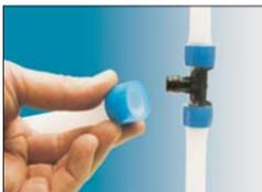
**Passo 3. Montar o anel na tubagem** de forma a que este sobressaia ligeiramente (máximo 1 mm) na extremidade do tubo. Se estiver a utilizar um anel com batente e ângulo de entrada, estas duas propriedades facilitarão a utilização do já referenciado anel bem como a sua montagem.
