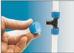
**Paso 3. Montar el anillo en la tubería** de forma que sobresalga ligeramente (máximo 1 mm) del extremo del tubo. En el caso de que el anillo cuente con tope y ángulo de entrada, estas dos propiedades facilitarán tanto el uso como el montaje del mismo.
