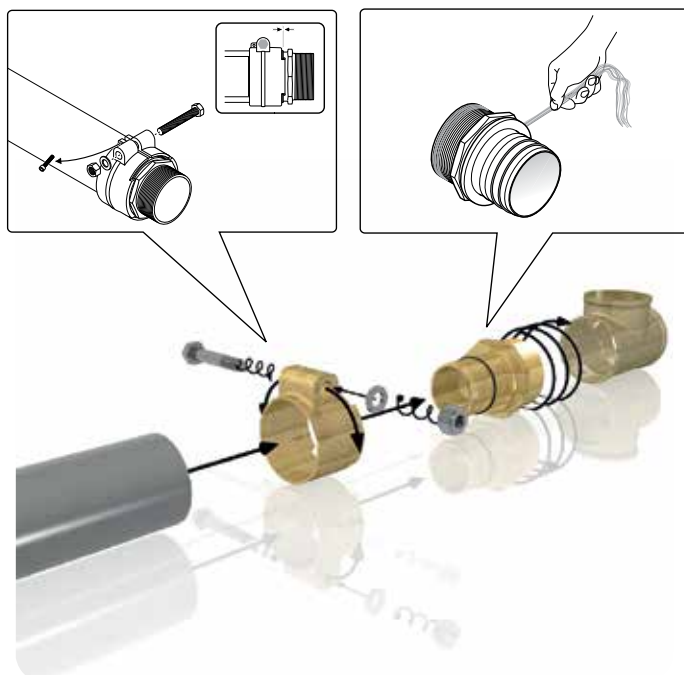
Uponor Wipex prechod pre rozmery potrubia 125 x 11,4 mm, PN 6
