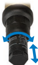
Bild: Förinställning av reglerventilen
