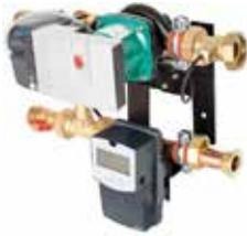
Si alguna de las estancias demanda temperatura, la bomba de circulación se pondrá en funcionamiento proporcionando el caudal adecuado para alcanzar la temperatura de consigna. De la misma forma, la válvula de 3 vías tiene como misión ajustar la temperatura de impulsión en función de las condiciones definidas.
