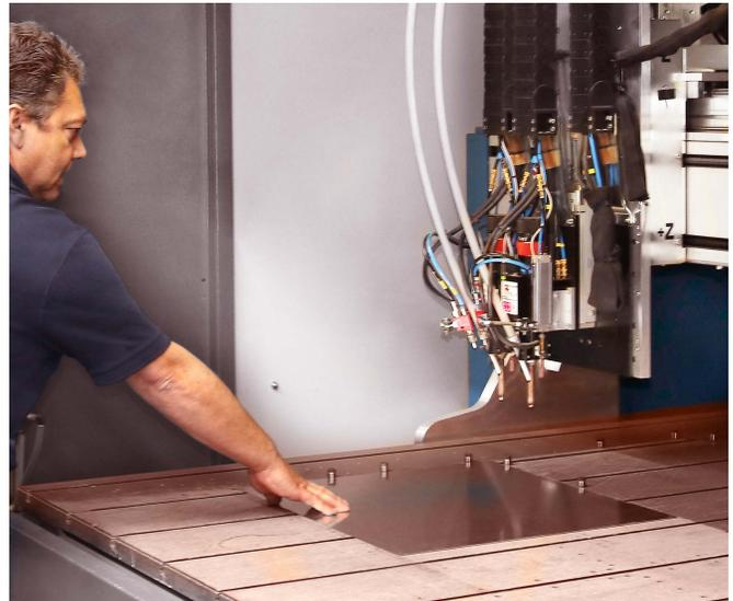
*Así nacen las unidades DUO, mecanizando las placas de acero con un diseño especial, que servirán de soporte para los diferentes elementos que componen las unidades comfort Port DUO*
