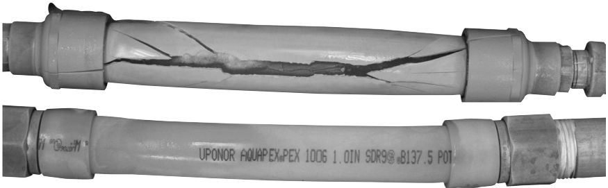
Figura C-2: Prueba de congelación CPVC vs. PEX
