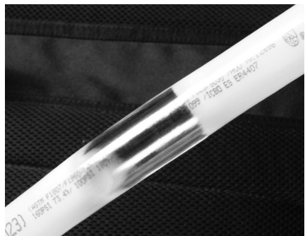
Figura C-1: Reformar la tubería retorcida
