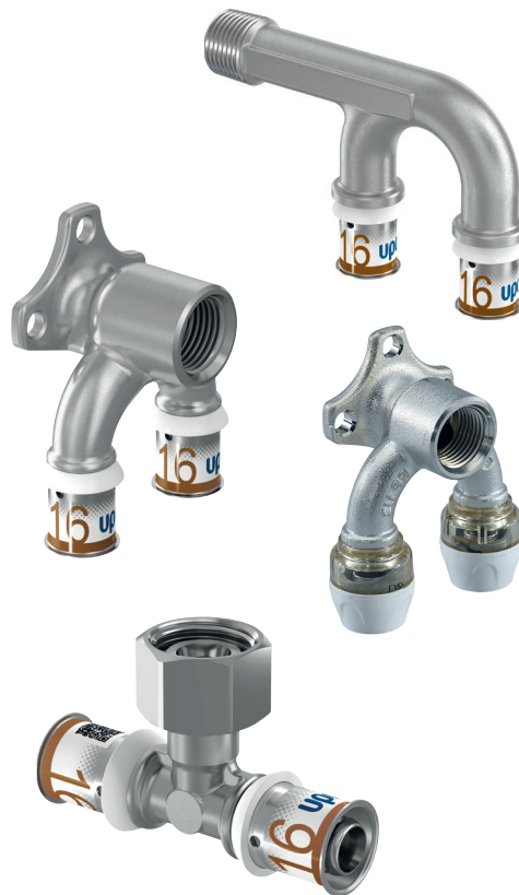
Az Uponor átfolyós falikorongok és a dupla kötésű berendezéscsatlakozók lehetővé teszik a higiénikus körvezetékes és sorba kötött rendszerek kialakítását.
