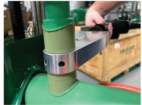
**Figura 2-8: Calentamiento de una salida de silleta**
