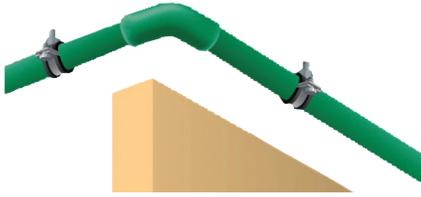
**Figura 5-4: Expansión con cambios de dirección**
