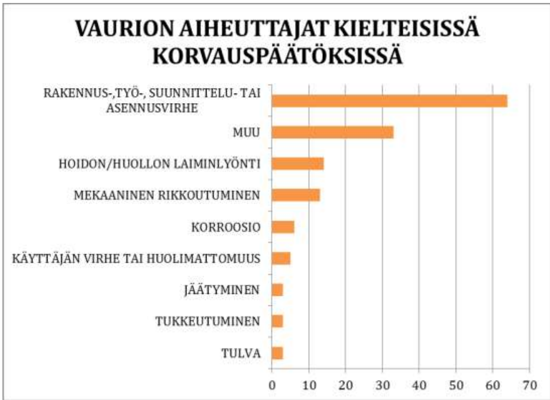
Kuva 2.3.5 Vaurion aiheuttajat kielteisissä korvauspäätöksissä
