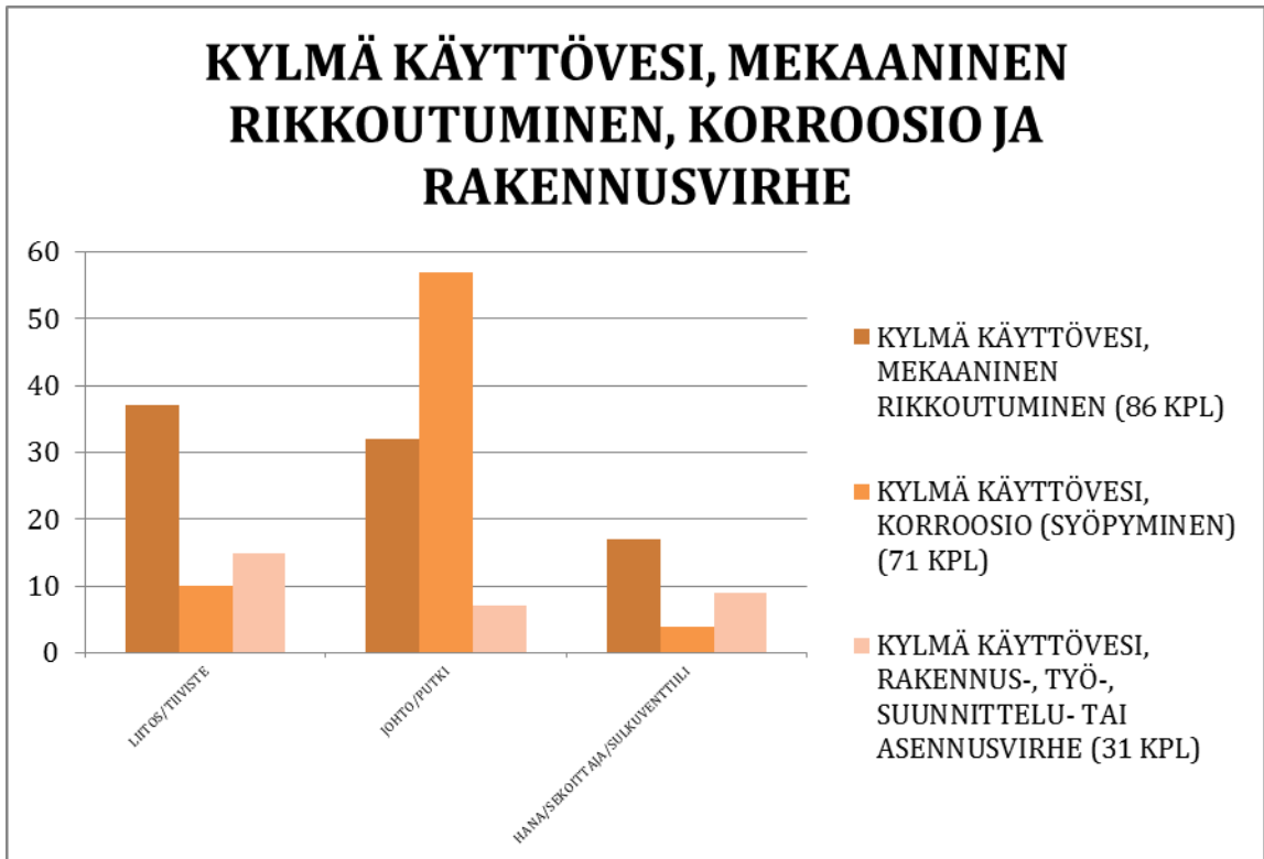
Kuva 2.2.28 Kylmän käyttöveden verkastoissa yleisimmin vuotaneet osat
