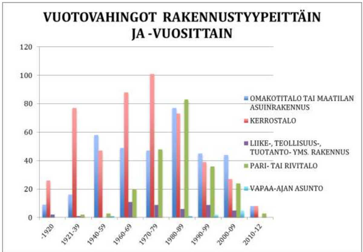
Kuva 2.1.6 Koonti vuotovahingoista rakennustyyppien ja -vuosien suhteen
