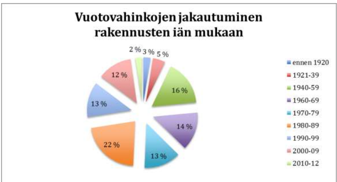
Kuva 2.1.4 Vuotovahinkojen jakautuminen rakennusten iän mukaan
