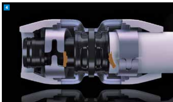
Kontrola Úspěšné zalisování uvidíte průhledkou. Pokud byl koncem potrubí barevný distanční prvek vytlačen, je zalisování dokončené.
