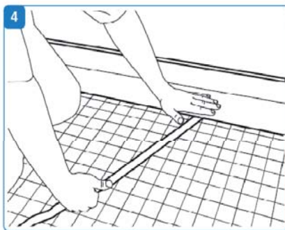
Přilepení fólie obvodového izolačního pásu
