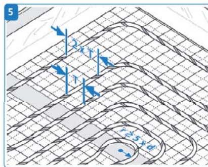
Pokládka potrubí v předepsané rozteči
