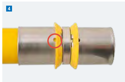
4 Insteekdiepte controleren in het kijkvenster
