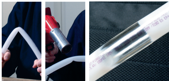
Пречупените тръби Uponor PE-Ха се изправят лесно с промишлен компресор.
