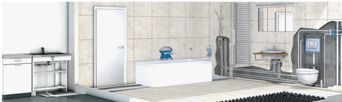
Zančni sistem instalacije v kuhinji in kopalnici
