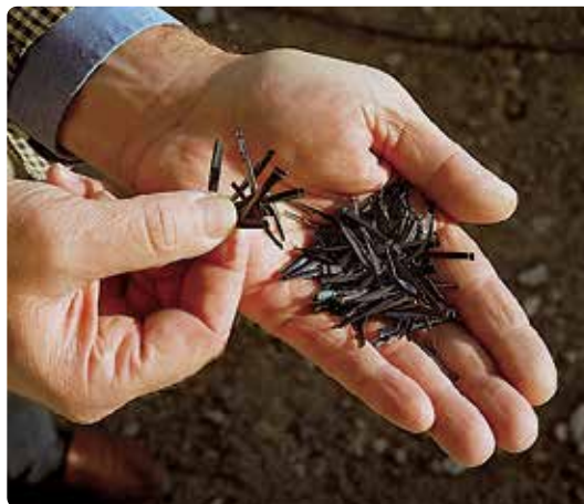
Trójwymiarowe mocowania betonu poprzez włókna stalowe.
