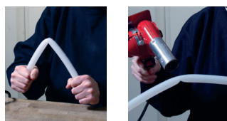
Los pinzamientos que se puedan producir en la tubería, se reparan fácilmente con un decaador de aire.
