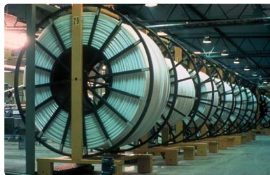
Wirbo-inPEX-rören kan tillverkas i längder upp till tusentals meter. Det reducerar behovet av skarvkopplingar, underlättar installationen och sänker kostnaderna.
