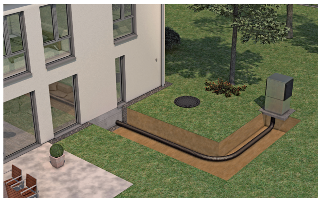
Conexión de Uponor Ecoflex Thermo Twin HP entre una bomba de calor externa monobloc y un edificio residencial.
