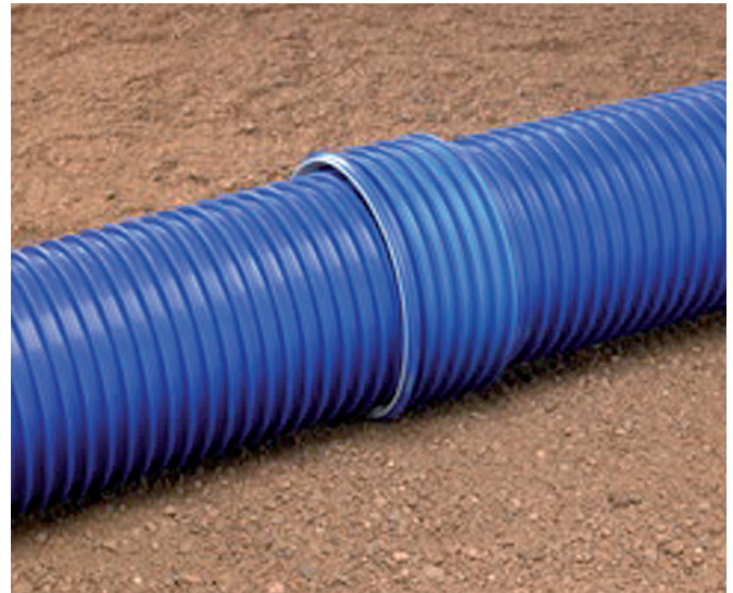
4. Sujutage toru sileots ühendusmuhvi põhjani. Toruotsa ja muhvipõhja vahele ei tohi jääda pilu. 4° ja väiksema suunamuutuse võite 200...315 mm läbimõõdu korral teha jätkukohas.
