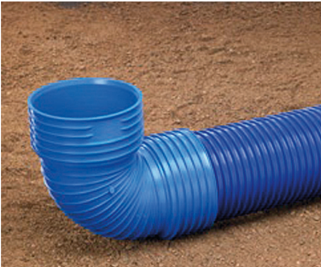
3. Sujutage toru sileots ühendusmuhvi põhjani. Toruotsa ja muhvipõhja vahele ei tohi jääda pilu. 4° ja väiksema suunamuutuse võite 200...315 mm läbimõõdu korral teha jätkukohas.
