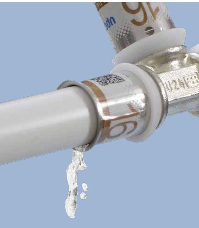
**Das S-Press PLUS Fitting ist unverpresst undicht: Durch das sichtbar austretende Wasser im unverpressten Zustand kann keine Pressstelle mehr vergessen werden und eventuelle Schäden verursachen.**
