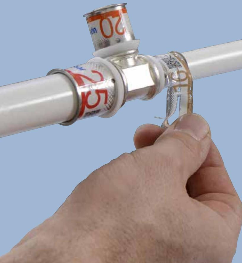
**Die S-Press PLUS Fittings sind mit einer speziellen Folie mit Dimensionsangabe ummantelt, die nach dem Verpressen einfach abgelöst werden kann und so zusätzlich zur „unverpresst-undicht“-Funktion eine doppelte Verpresstkontrolle bietet.**
