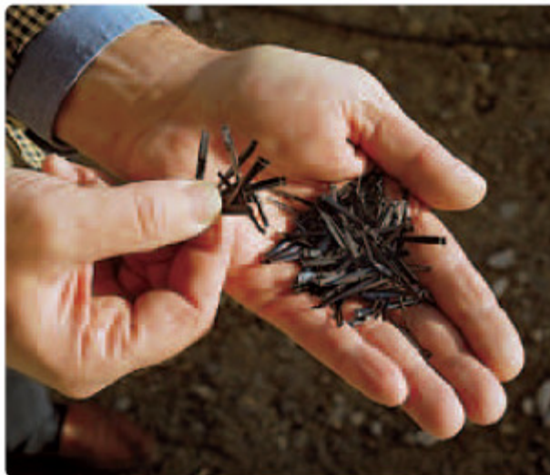
Tridimenzionalno sidranje betona z jeklenimi vlakni.
