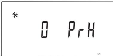
Seleccione esta función para activar un programa de precalentamiento del suelo/solera. El programa de precalentamiento se utiliza para evitar daños a sistemas de calefacción por suelo radiante recién instalados, según la norma DIN 1264-4.
