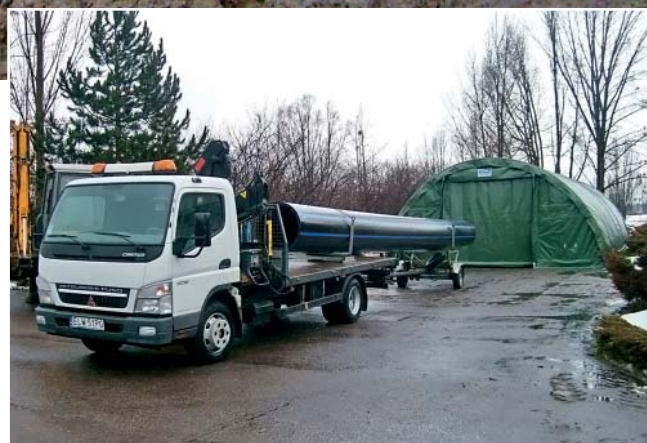
Fot. 2. Zestaw dłużycowy do transportu rur – Idealny do ścisłego centrum
