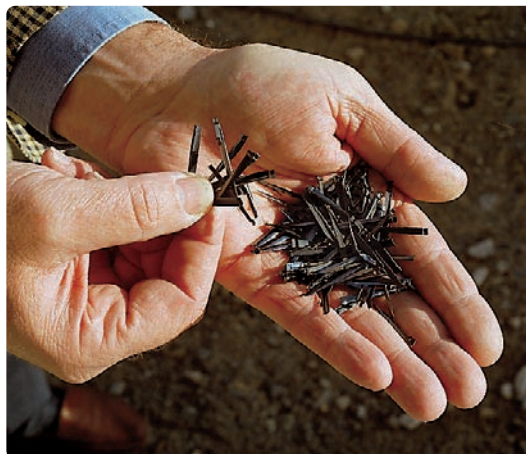
Trojrozměrné ukotvení betonu pomocí ocelových vláken.
