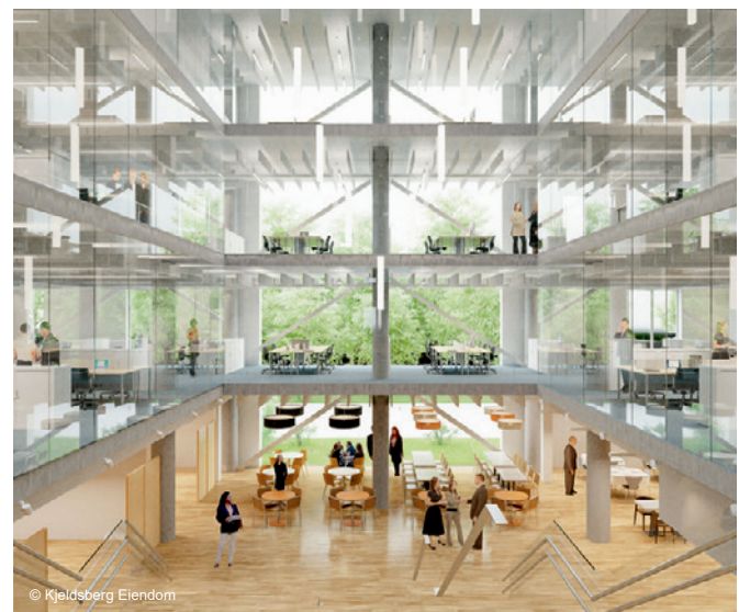
Anlagenkonzept mit Betonkernaktivierung und vertikalen Deckenelementen zur Schallabsorption.
