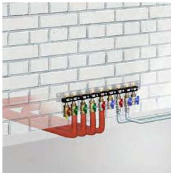
La placa de conexión con válvulas de corte se instala sobre la pared.
