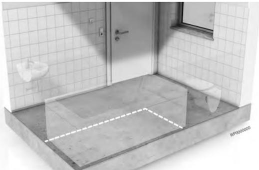
Il supporto (sottofondo) deve essere adeguato alla posa. In particolare, controllare che sia perfettamente piano e resistente. Se necessario, compensare il substrato o prepararlo per l'installazione dell'impianto di riscaldamento a pavimento elettrico Uponor Comfort E. Prima della posa, conoscere e osservare le normative e le linee guida pertinenti per la sezione pavimento.
