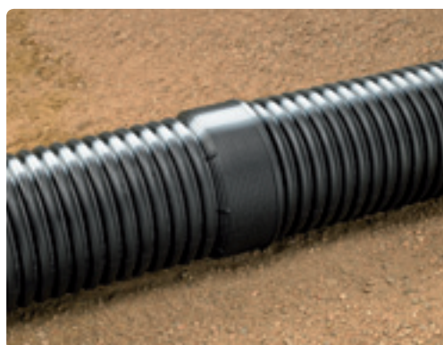
4. Røret skal monteres i bunnen av muffen. Man kan lage et innstikkmerke, slik at man er sikker på at man har nådd bunnen med spissenden.
