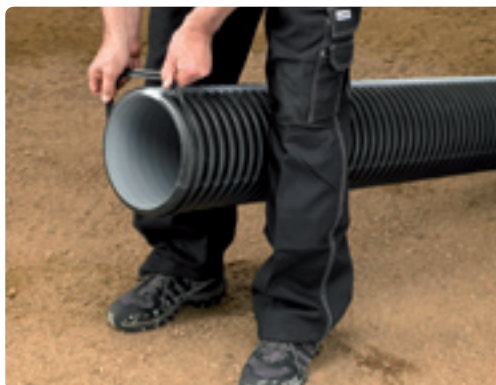
2. Ved tett rørsystem monteres pakningen som settes i det første sporet fra spissenden. Pakningen monteres med de to profilene ned i sporet.
