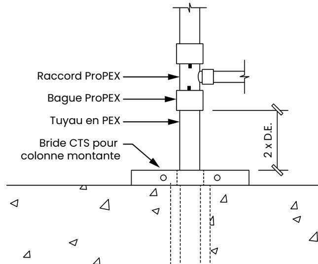
**Figure 6-20 : Exemple de distance des brides**
