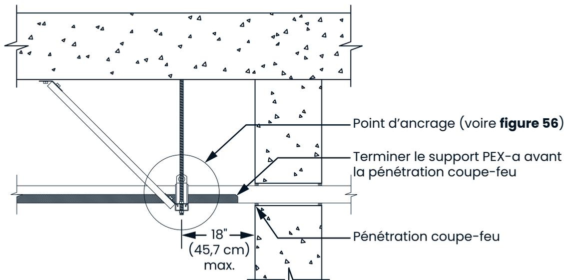
**Figure 6-15 : Points d'ancrage près d'une pénétration coupe-feu (horizontale)**
