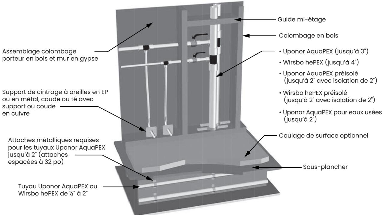
Figure 3-2 : Détail pour branchement d'appareils 1 (E.-U.)
