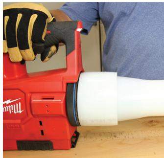
**Figure 2-18 : Dilater jusqu'à la butée**
