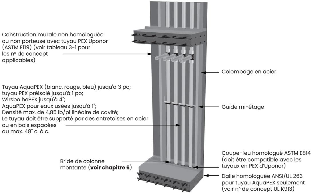
**Figure 3-10 : Détails pour constructions en béton (E.-U.)**
