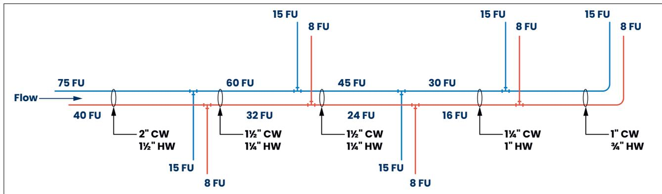
**Figure 5-10 : Application des données du tableau 5-8 au plan de plomberie**
