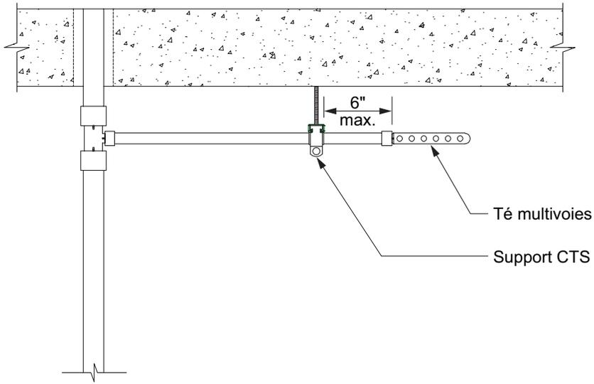
**Figure 6-12 : Support de tés multivoies dans les applications suspendues**
