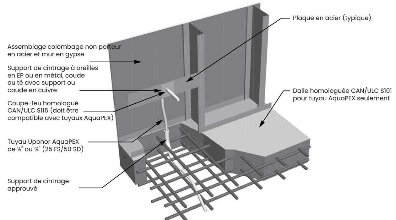
**Figure 3-12 : Détail pour branchement d'appareils (Canada)**
