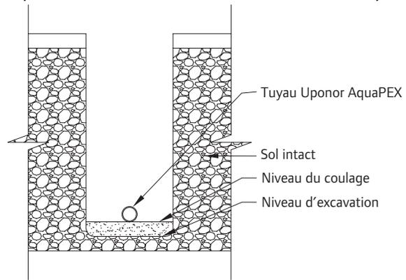
**Figure 6-25 : Condition du sol défavorable** — En la présence de conditions défavorables (p. ex., sol rocailloux ou boueux, etc.), il peut être nécessaire de préparer la tranchée en utilisant un matériau granulaire de dimension et de classification adéquates afin d'assurer une base stable. Consultez votre code local pour les exigences additionnelles.
