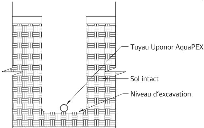
**Figure 6-24 : Condition du sol favorable** — Si l'excavation de la tranchée se fait sans problème, installer la tuyauterie directement sur le fond préparé. Le fond doit être plat, sans trous, bosses ou cailloux.
