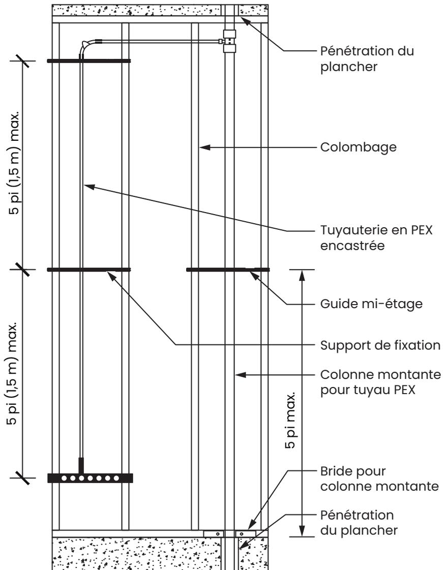
Figure 6-16 : Tuyauterie encastrée vs colonne montante
