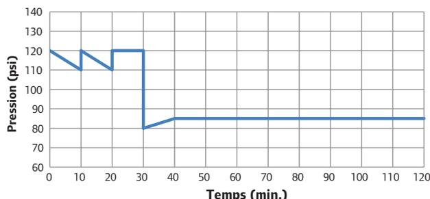
**Figure 6-27 : Graphique d'essai de pression**
