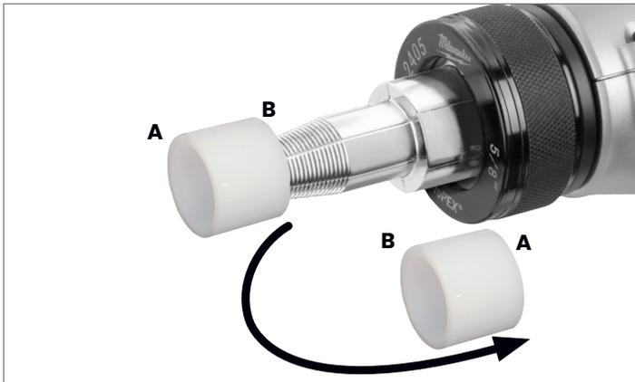
Figure 2-31 : Dilater chaque côté de la bague
