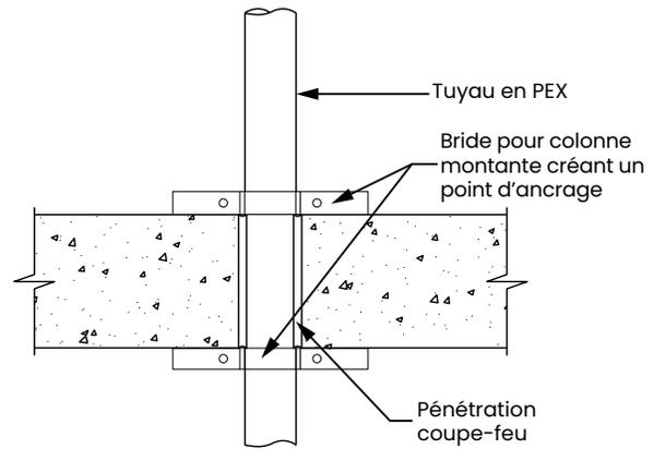
**Figure 6-18 : Exemple de point d'ancrage 2 (tuyauterie verticale)**
