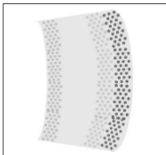
**Figure 1-2 : PEX-b (silane) réticulé à 65-70 %**
