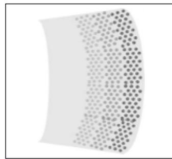
**Figure 1-3 : PEX-c (irradiation) réticulé à 70-75 %**
