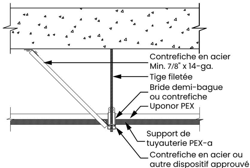
**Figure 6-14 : Point d'ancrage**
