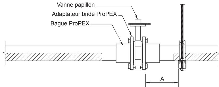
**Figure 6-5 : Supports pour vannes papillon de 2½" à 3"**
