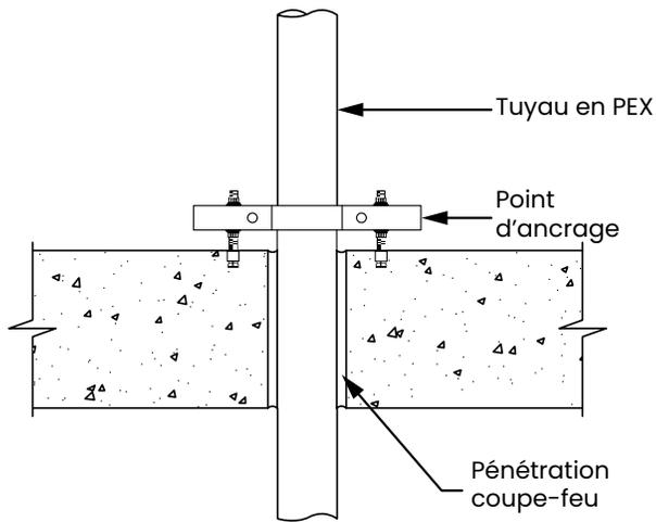
**Figure 6-17 : Exemple de point d'ancrage 1 (tuyauterie verticale)**
