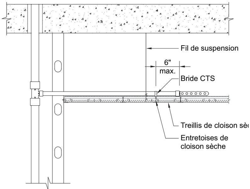
**Figure 6-13 : Support de tés multivoies sur une grille de cloison sèche**
