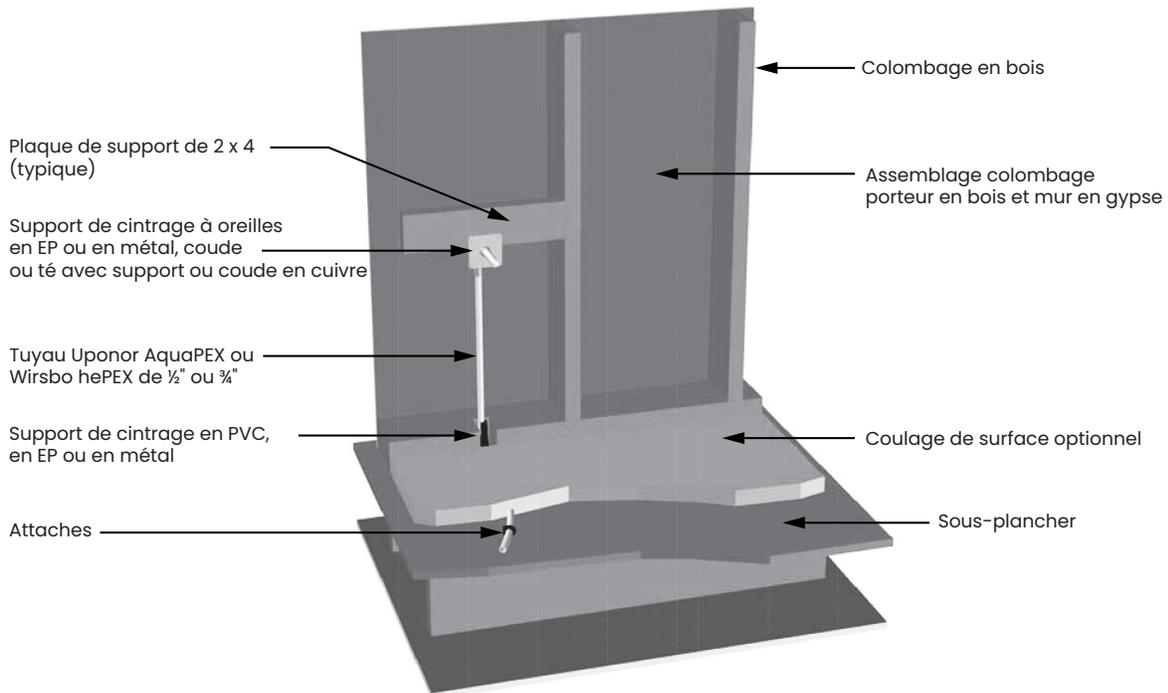
Figure 3-3 : Détail pour branchement d'appareils 2 (E.-U.)
