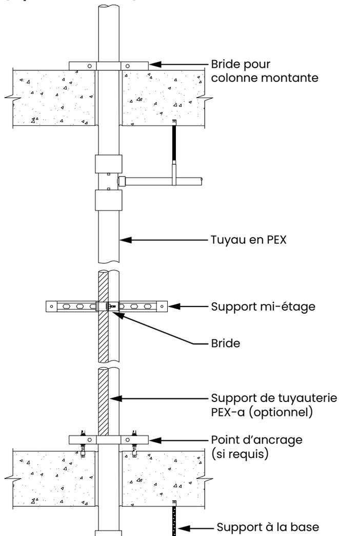
**Figure 6-19 : Schéma détaillé de la colonne montante**
