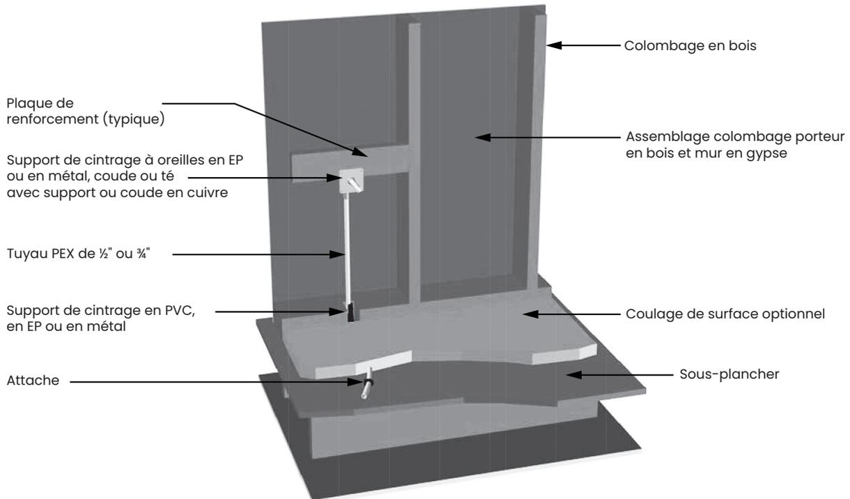
Figure 3-7 : Détail pour branchement d'appareils 2 (Canada)
