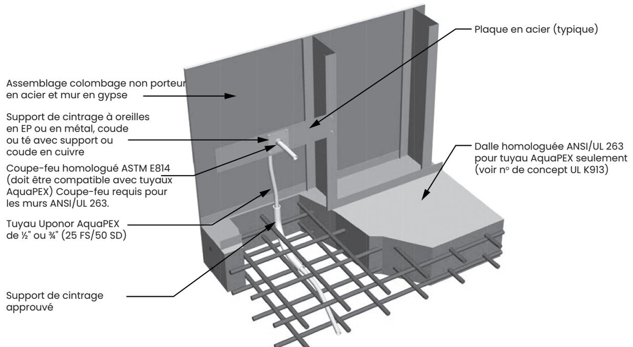
Figure 3-9 : Détail pour branchement d'appareils (E.-U.)
