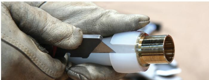
Figure 2-34 : Retirer la bague
