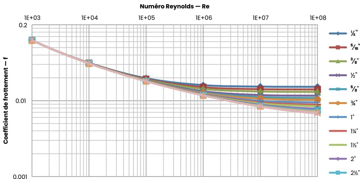
Le facteur de frottement peut également être trouvé en utilisant un diagramme de Moody standard. Le diagramme de Moody est une fonction du nombre de Reynolds et du rapport entre la rugosité du tuyau et le diamètre interne. Consulter la **figure 4-2** pour le diagramme de Moody applicable aux tuyaux en PEX.
