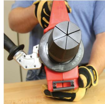
**Figure 2-13 : Alignement correct de la tête de dilatation**
