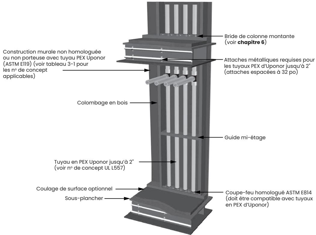
**Figure 3-4 : Détail pour ossature en bois (É.-U.)**
