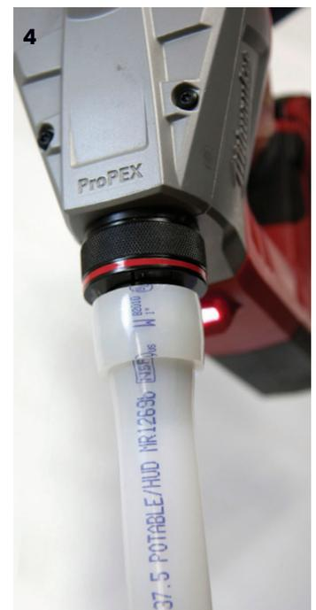
Figure 2-9 : Dilatation avec l'outil ProPEX Milwaukee M18
