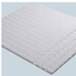
Uponor Siccus Verlegeplatte – Verlegeplatte aus EPS mit Rohr-führungskanälen zur Aufnahme der Uponor Siccus Wärmeleitlamellen. Verlegeabstände 15/22,5/30 cm.
