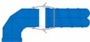
Sammenføring af rør med momenttaljer.
