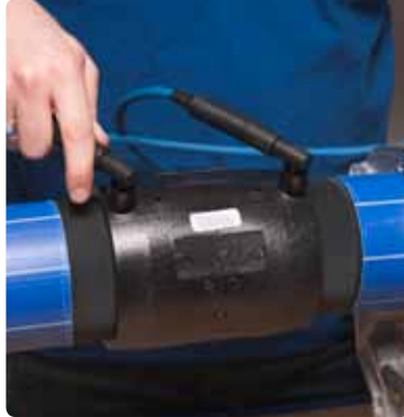
8. Derefter foretages elektrosvæjsning.
