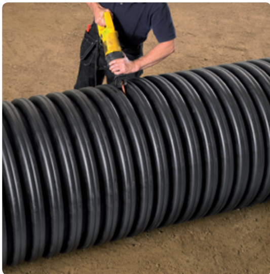
1. Toru lõigatakse kahe ribi vahelt nt tikksae abil parajaks.
